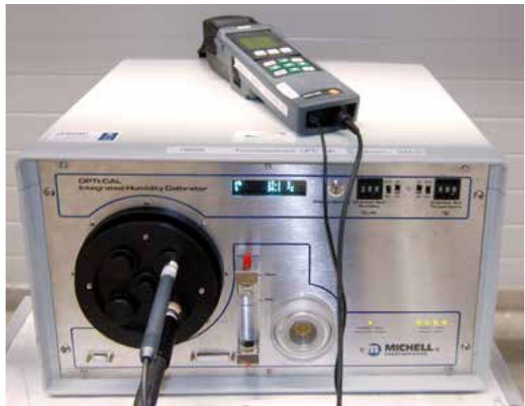
Kalibrierung von Feuchtesensoren
